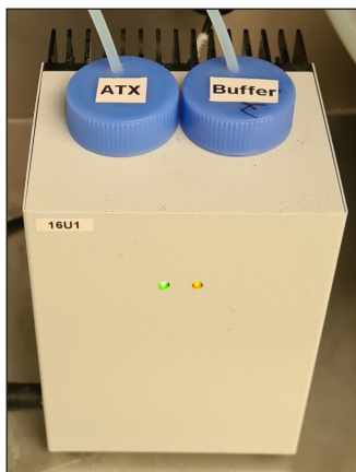
Plaatsing van de ATX-buis in het koelblok
