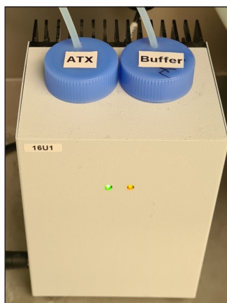
Plaatsing van de bufferbuis in het koelblok
