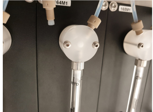
Afbeelding van welke slang u moet verwijderen van de pomp bij het gebruik van ethanol
